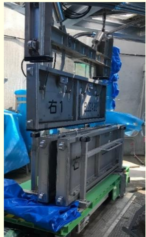
完成した表面取水ゲート（角落し）
